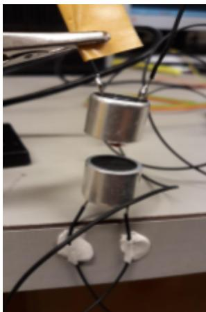
Figure 5: Test avec 2 émetteurs face à face
